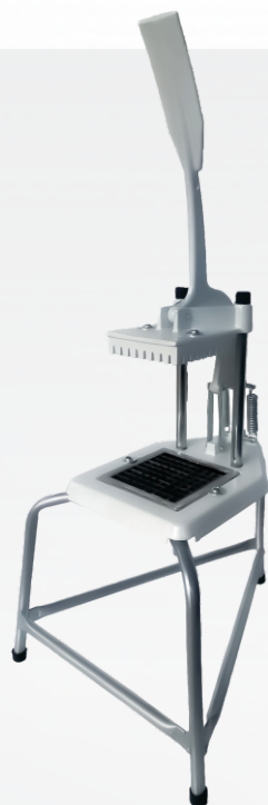
PLCMTB-03 Cortador Médio com tripé baixo Facas: Aço Inox 10 MM Macho: Polipropileno Corpo: Alumínio fundido Pintura: Eletrostática a pó
